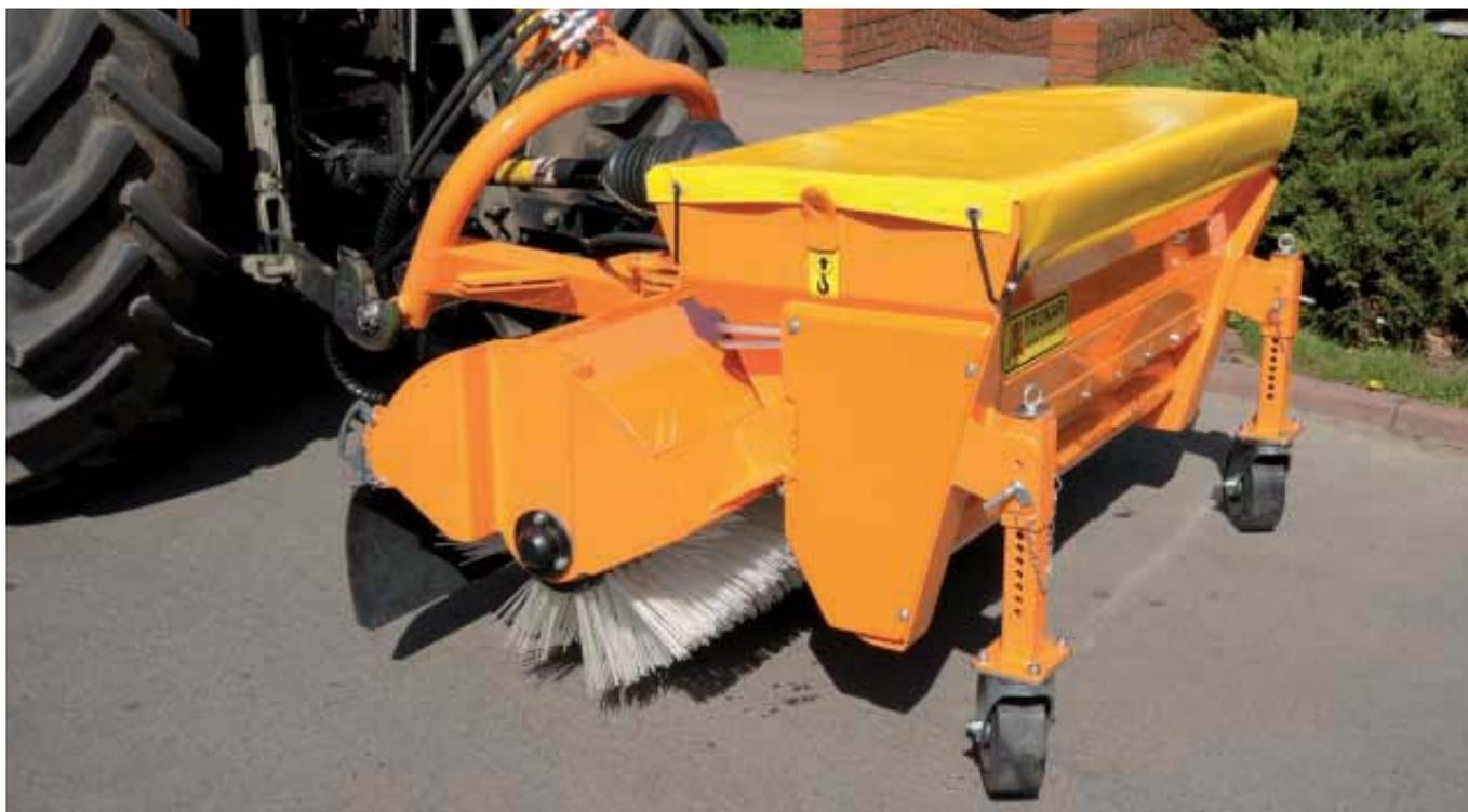
Подметально-уборочная машина ZM-P16 с приводом от ВОМ трактора
