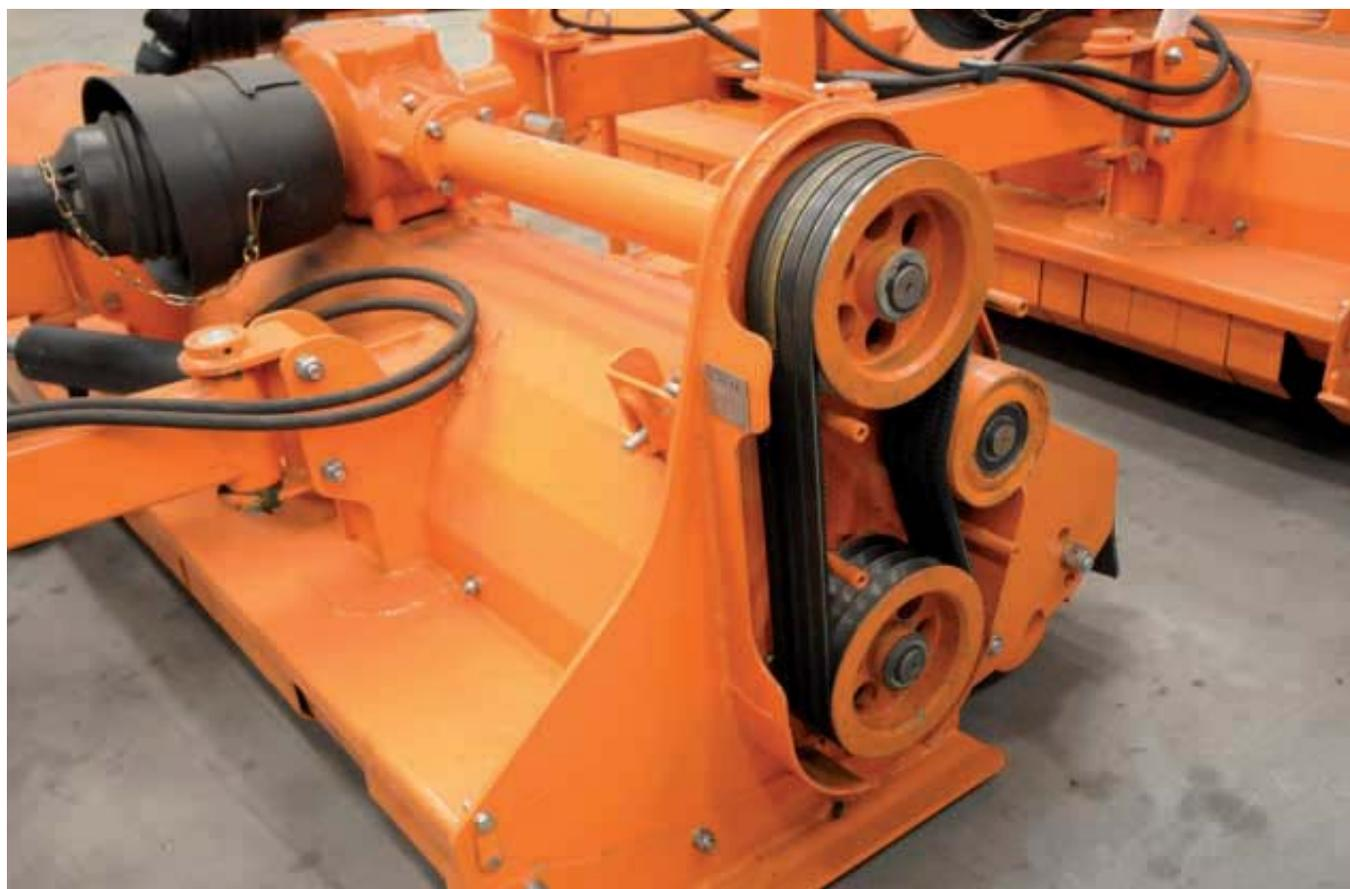
Ременная передача, которая выполняет роль предохранительного сцепления
