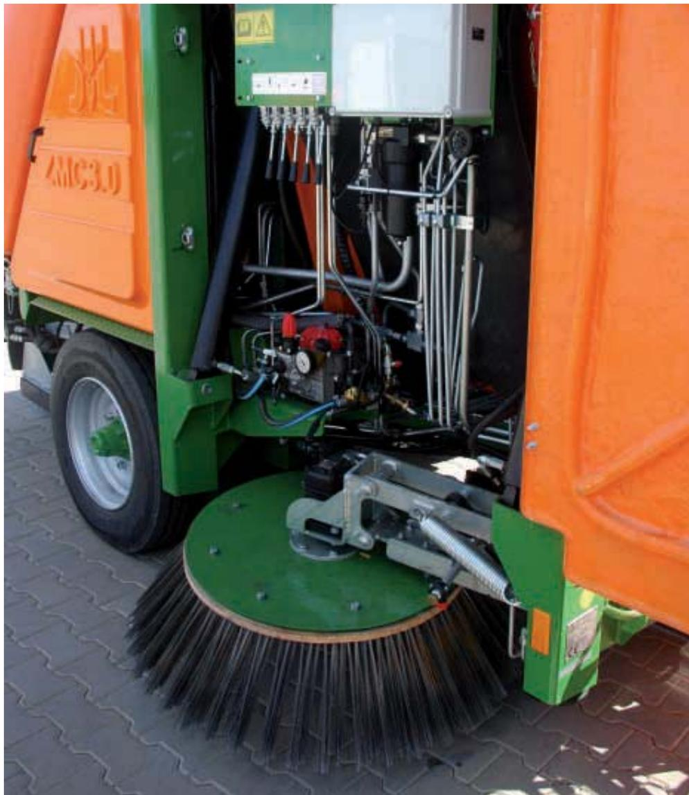
*Щетки-подборщики – регулировка угла наклона подметания*
