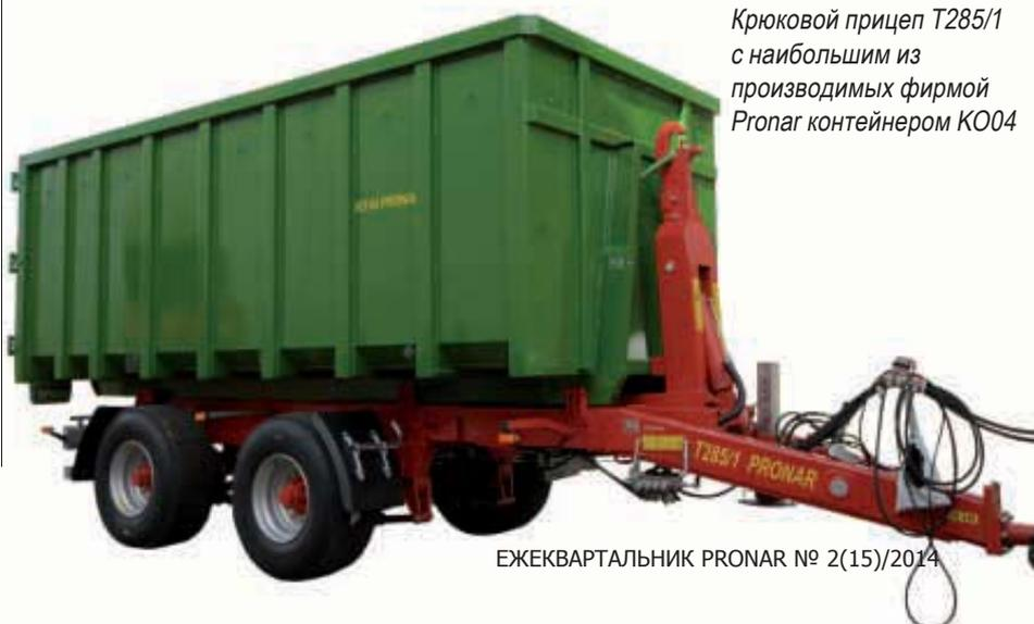
Крюковой прицеп T285/1 с наибольшим из производимых фирмой Pronar контейнером KO04
