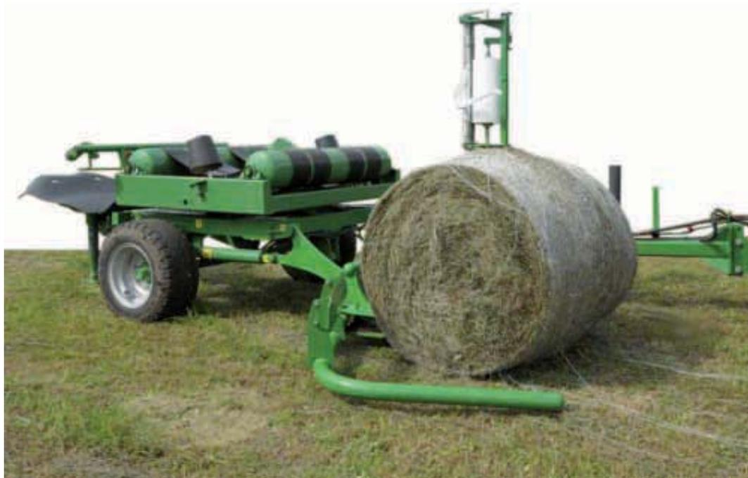
Передняя загрузка тюков в обмоточной машине PRONAR Z245/1
