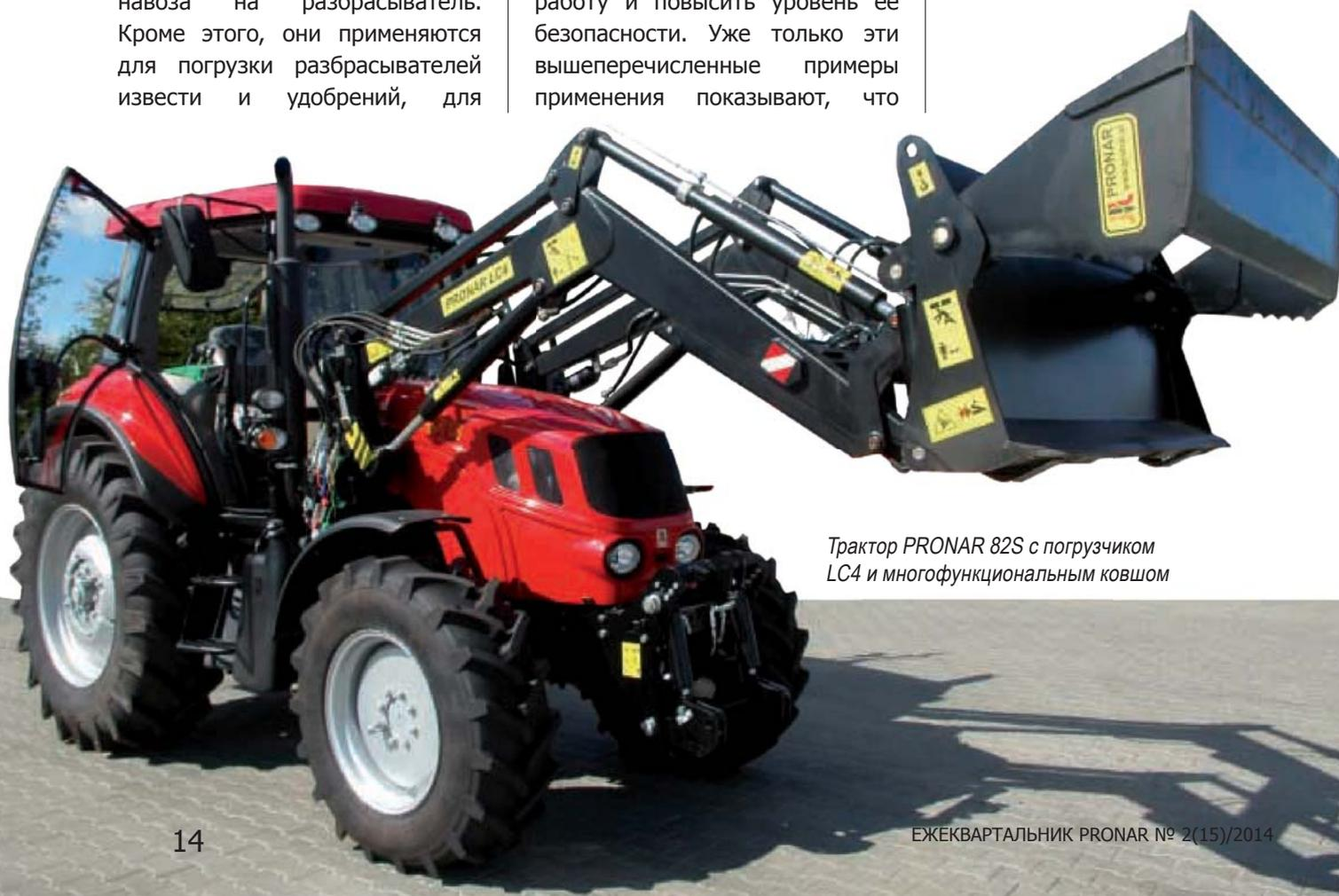
Трактор PRONAR 82S с погрузчиком LC4 и многофункциональным ковшом
