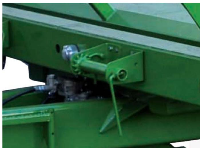
Два устройства с защелкой для втягивания ремней либо тросов, используемых для защиты груза в прицепе PRONAR T024M
