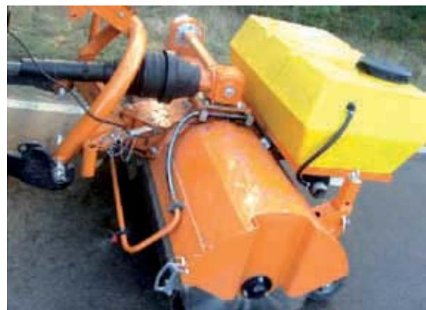
Дополнительное оборудование подметально-уборочных машин системой полива существенно снижает нагрузку на окружающую среду
