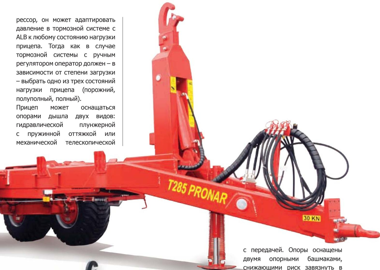
с передачей. Опоры оснащены двумя опорными башмаками, снижающими риск застрять в почве.
