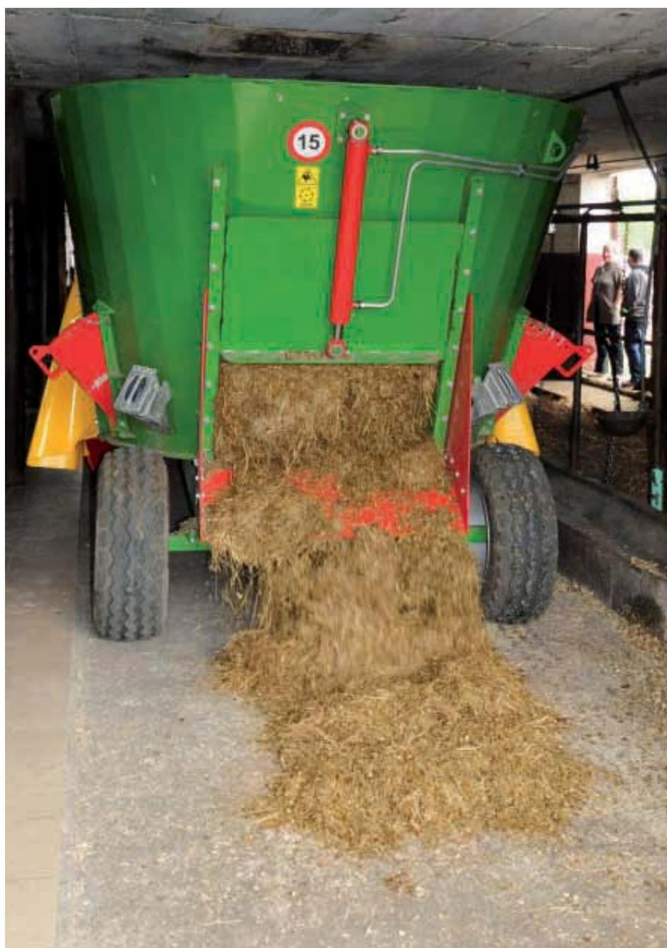
Новейший кормораздатчик PRONAR VMP-5T имеет задний высыпной люк, а также один или два боковых высыпных люка
