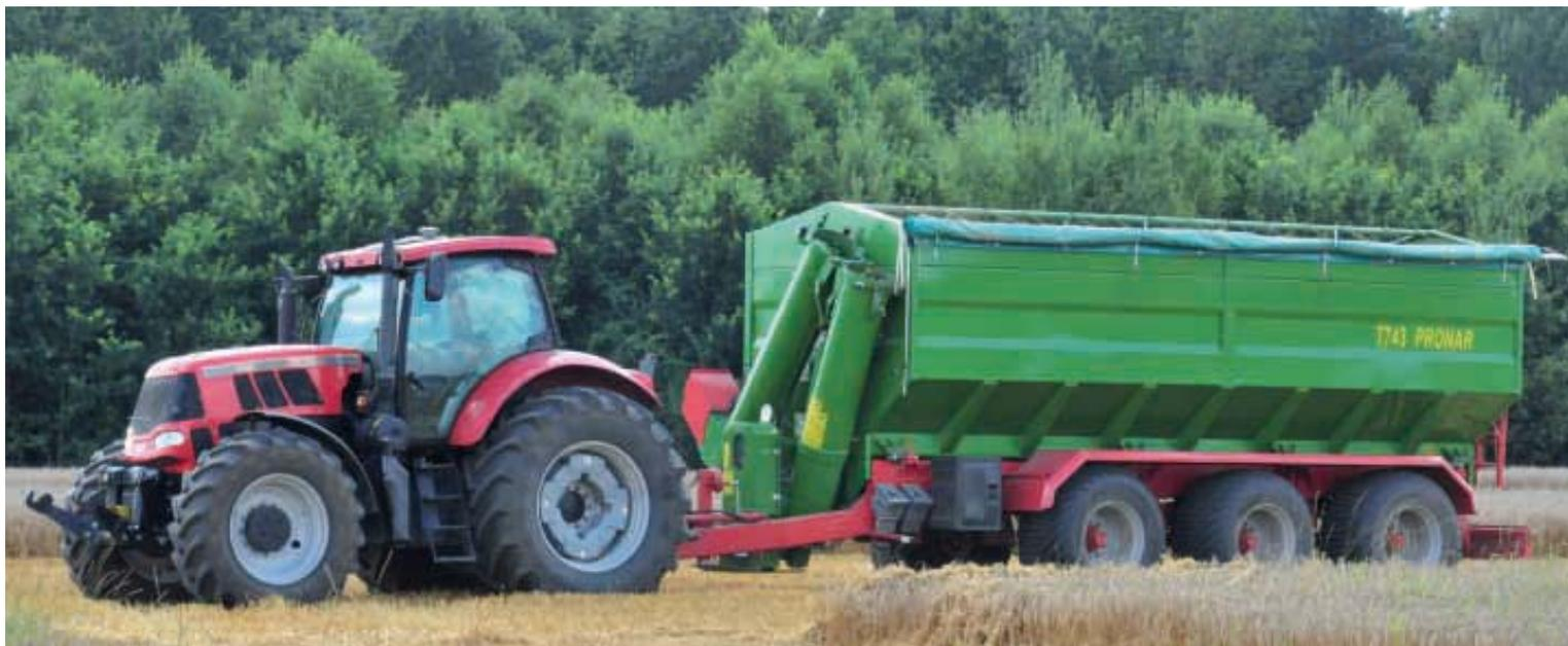
*Быструю разгрузку зерна в перегрузчиках PRONAR обеспечивает труба конвейера, складываемая гидравлически*
