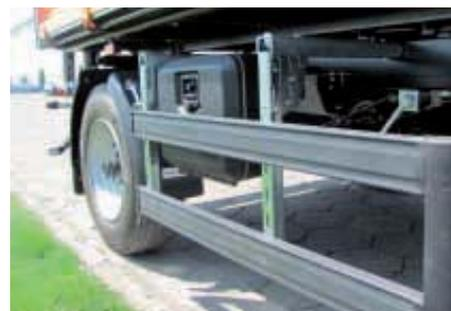
Ящик с инструментами (дополнительное оборудование) защищен противонаездными барьерами
