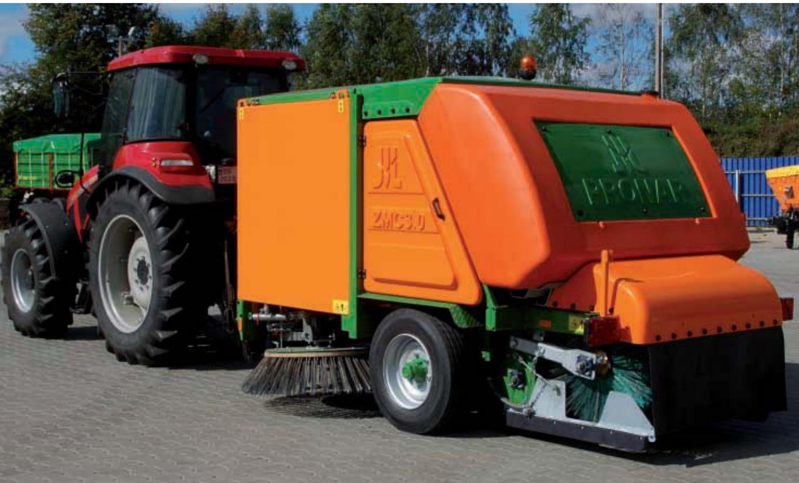
нижним транспортным крюком. Носитель приводит машину в действие с помощью приставки (мультипликатора), расположенной на вале отбора мощности. На приставке находится масляный насос, с помощью которого гидравлическая система приводит в действие отдельные рабочие узлы подметальной машины – подметающую систему с транспортером, систему поливки и опорожнения бункера.
