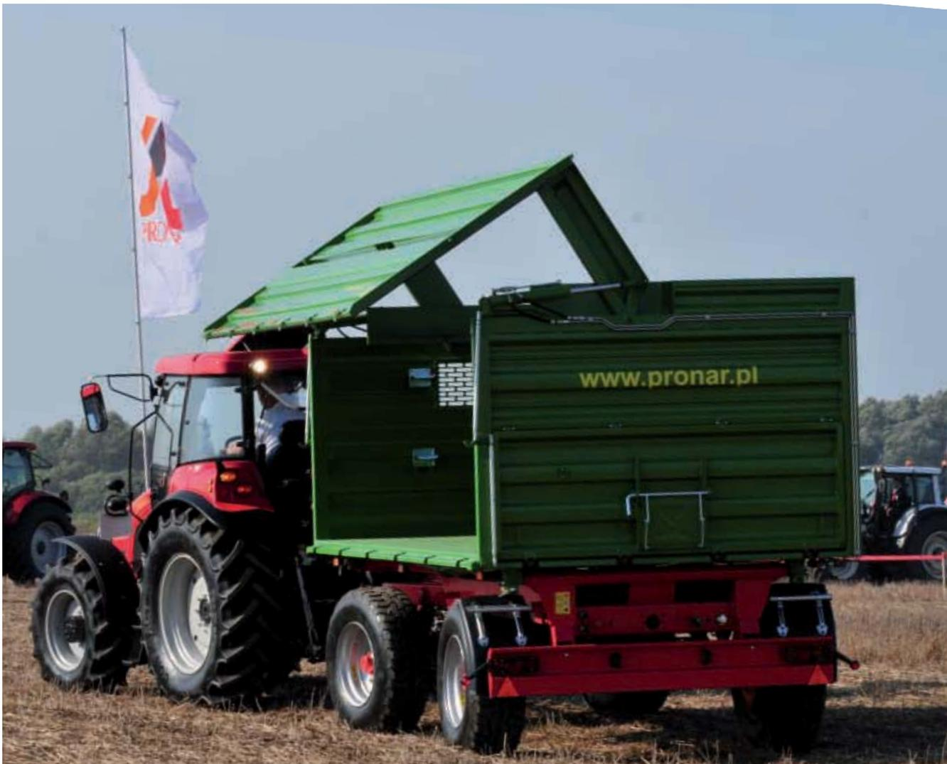
*Левая боковая стенка прицепа PRONAR T680H в виде сплошной профилированной плиты поднимается и блокируется с помощью гидроустановки*
