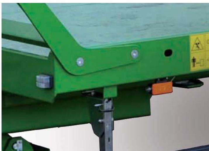
Двухточечная система крепления лестницы, при соответствующем закреплении груза позволяющая отказаться от поддерживающих ступеней
