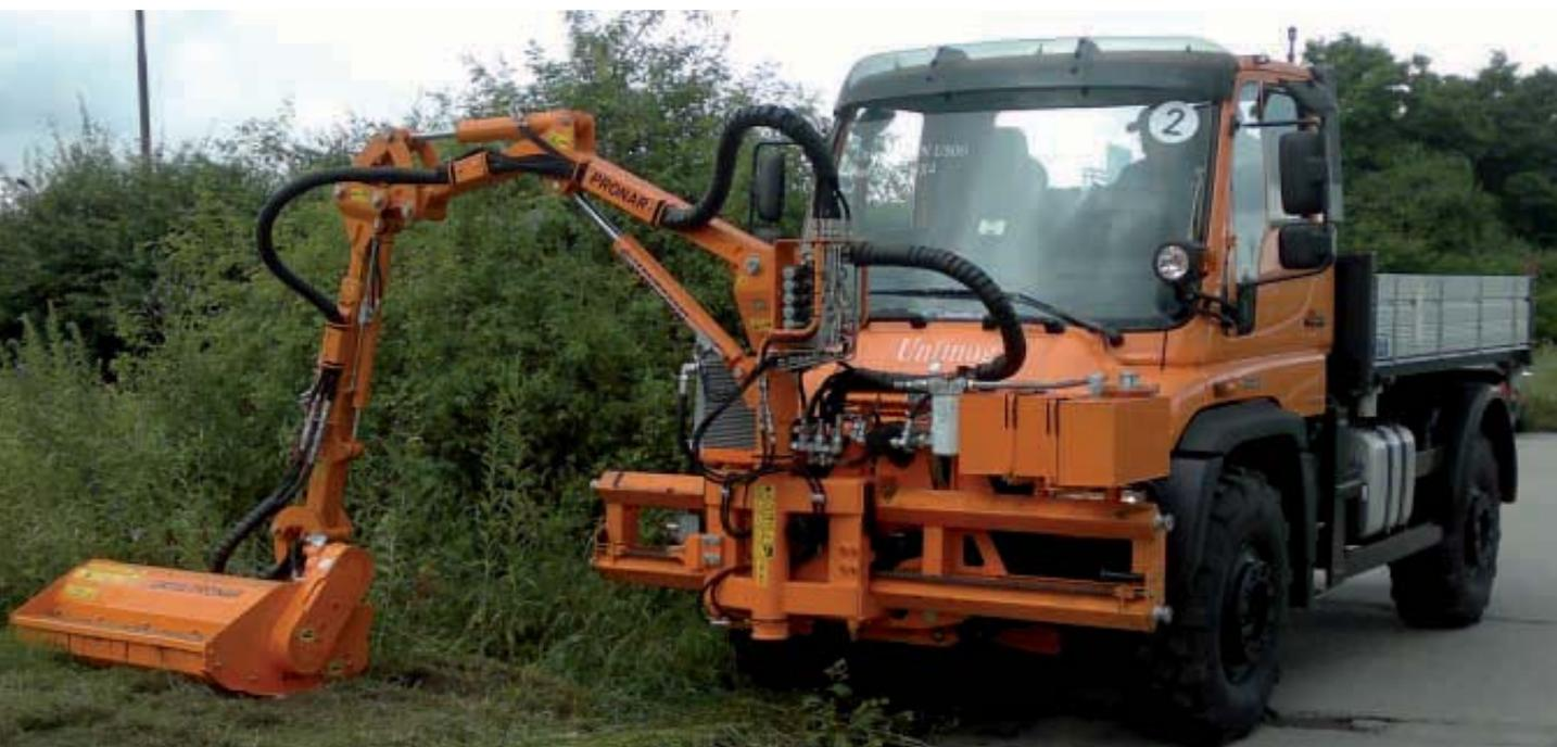
WWP500U с косящей головкой GK110, установленная на Unimog 500
