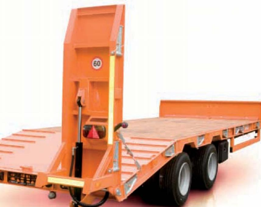
Трапы с гидроуправлением прицепа PRONAR RC2100
