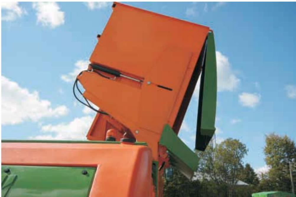
*Выгрузка из мусорного бака с помощью гидравлической системы без выхода из кабины*
