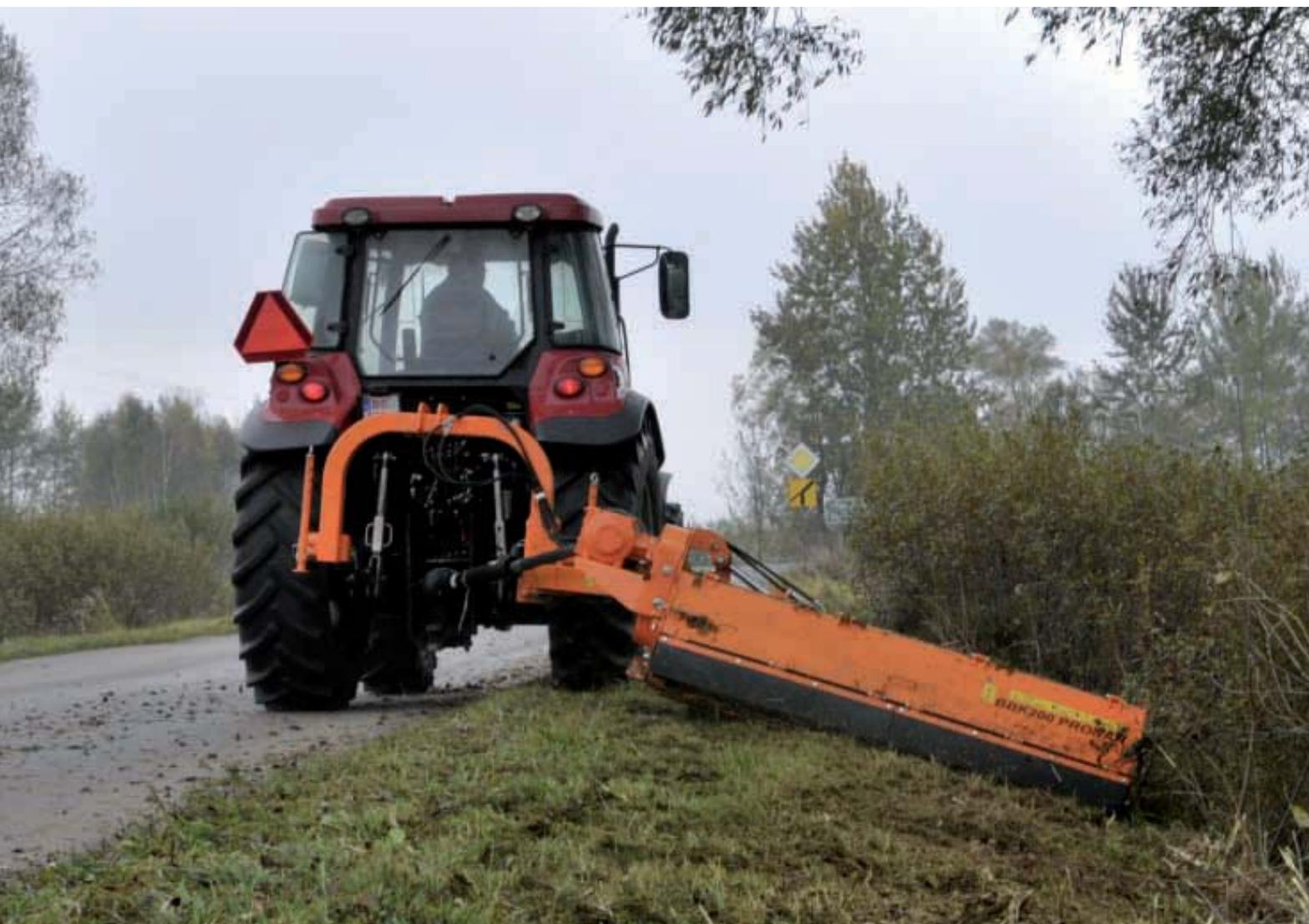
смещения, что обеспечивает максимальное смещение косилки на 1820 мм. Это облегчает маневрирование косилки между деревьями, столбами, знаками или дорожными ограждениями, не меняя траектории движения.
