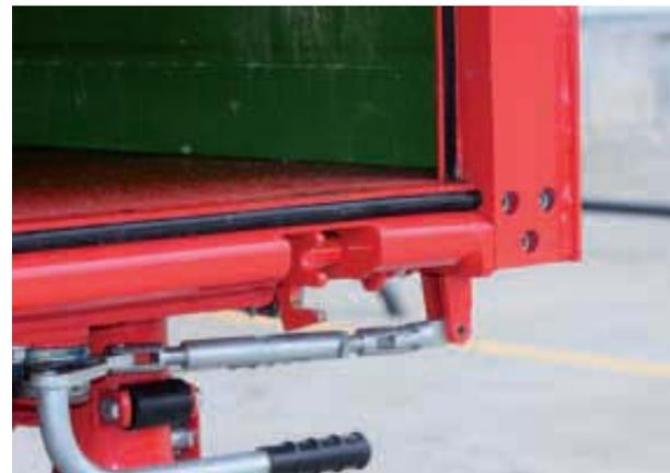
Сменная резиновая уплотнительная прокладка плиты пола прицепа PRONAR T680U, обеспечивающая герметичность грузовой платформы
