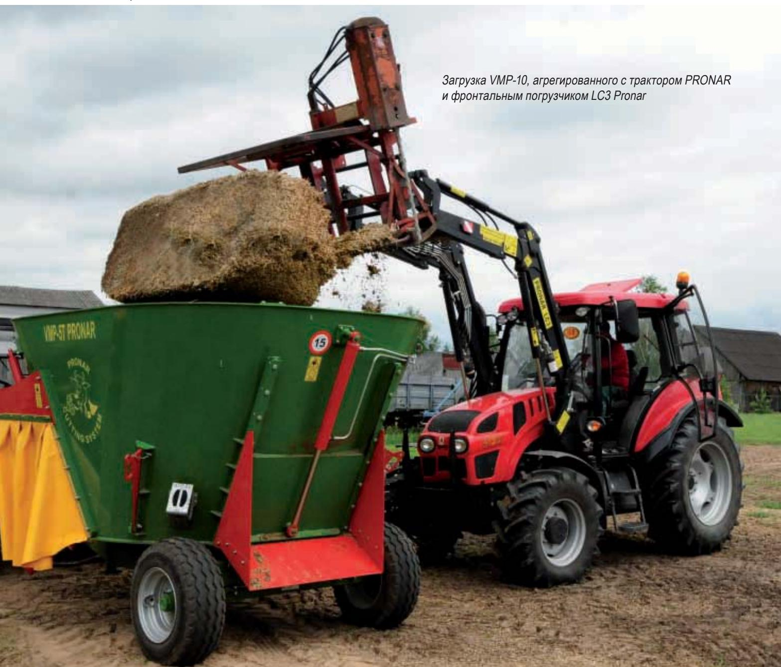
Загрузка VMP-10, агрегированного с трактором PRONAR и фронтальным погрузчиком LC3 Pronar
