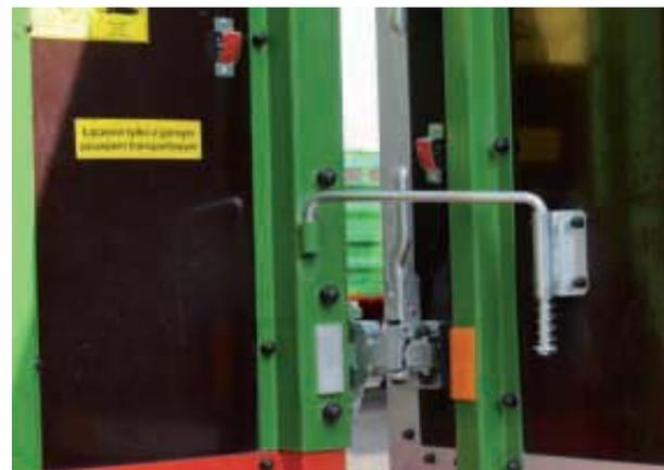
Блокировка порталного борта прицепа PRONAR T680P, предотвращающая самопроизвольное закрытие борта и его повреждение
