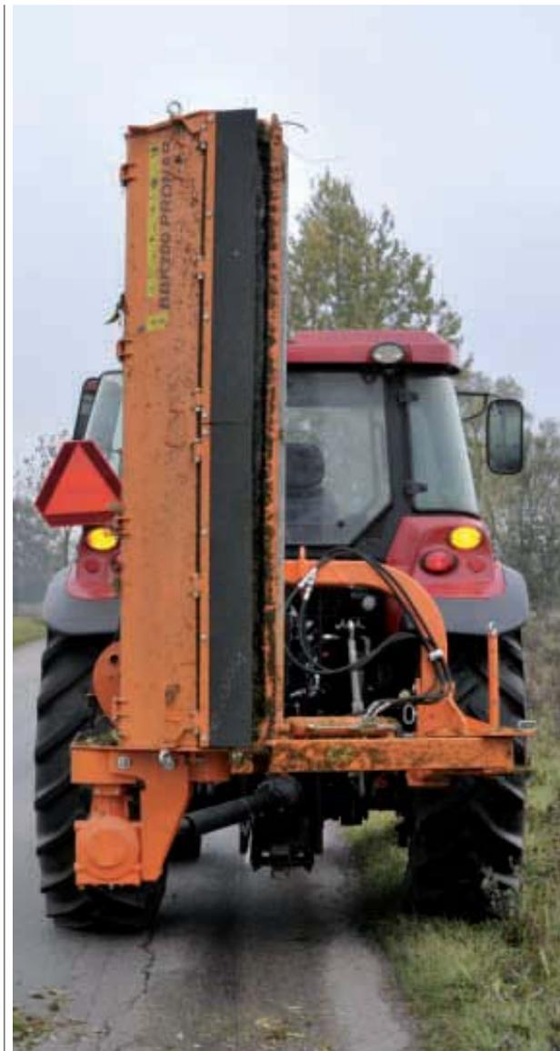
*Транспортировочное положение дисковой косилки с системой задней и боковой навески PRONAR ВВК200*
