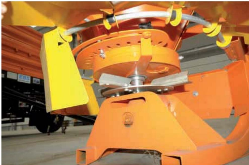
*Пескоразбрасыватель PRONAR PS-250. Перед зимним сезоном требуется проверка систем: приводной, разбрасывающей и системы подачи*
